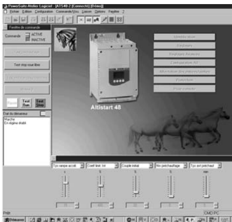
Отображение команд и настроек с помощью ПО PowerSuite на ПК
