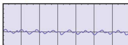
Пульсации момента с 17-битным энкодером
