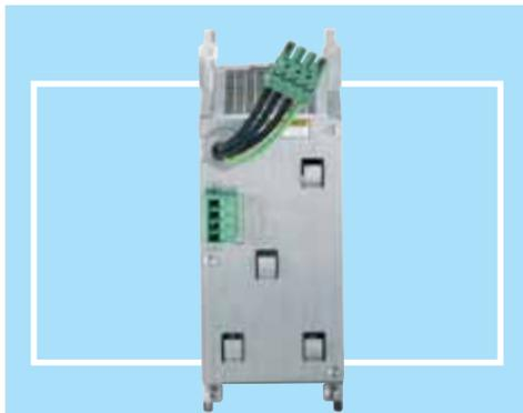
Крутые фронты сигналов современных преобразователей в сочетании с длинными кабелями электродвигателя часто ведут к возникновению переходного перенапряжения на клеммах электродвигателя. В результате использования фильтра электродвигателя на выходе преобразователя это перенапряжение уменьшается, а токи утечки в кабелях электродвигателя снижаются.
