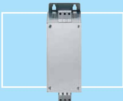
Комбинация сетевого фильтра и дросселя в одном устройстве упрощает механическую установку и облегчает электромонтаж. В результате закрепления сетевого фильтра с дросселем на нижней стороне преобразователя получается особенно компактный единый блок. Одновременно это упрощает соблюдение требований стандарта EN 61800-3, класс А, группа 2
